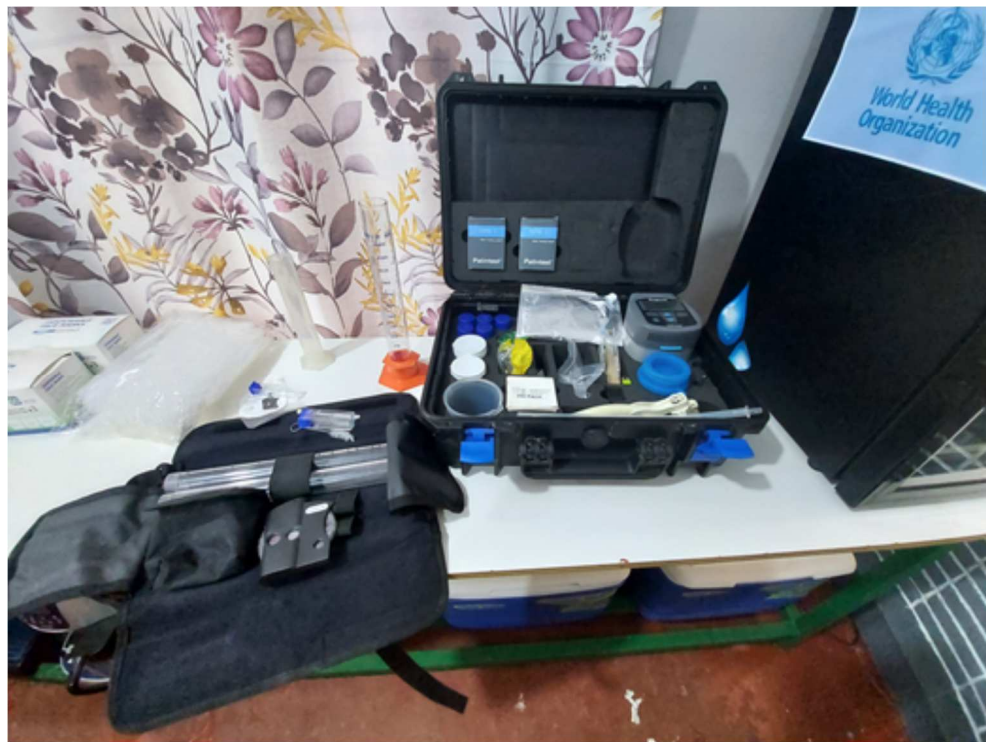
Photo 33. Unité portable d'Analyse terrain de qualité d'eau
