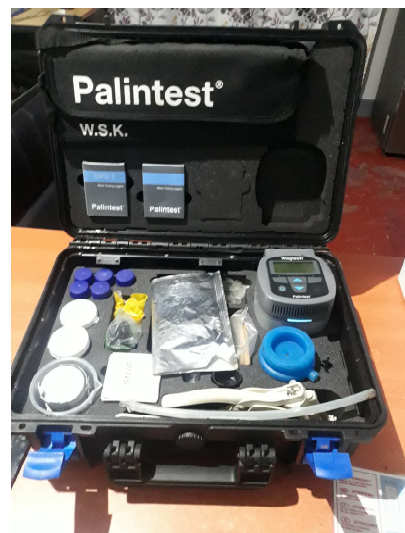
Photo 35. Unité portable d'Analyse terrain de qualité d'eau
