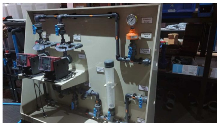
Photo 19. Pompe doseuse et unités de contrôle/ South-Africa
