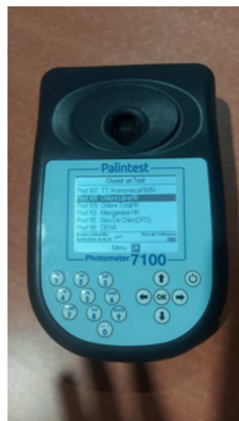
Ph 38. Photomètre d'analyse des paramètres physico-chimiques de l'eau
