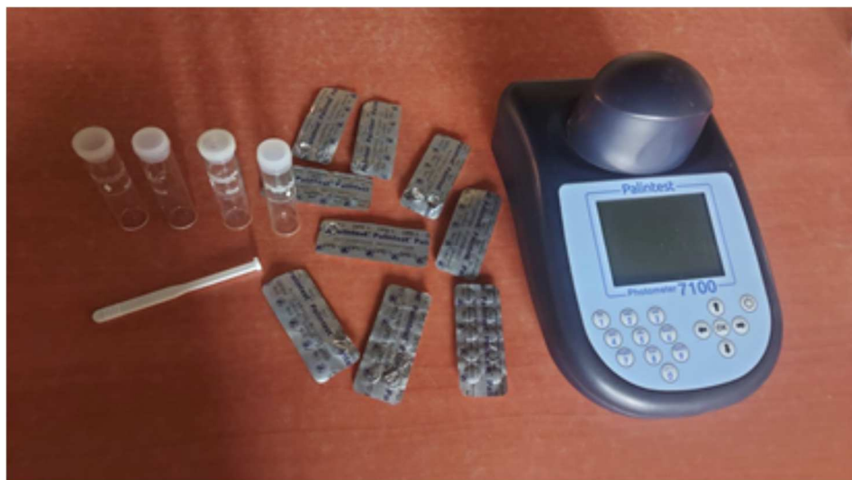
Photo 34. Photomètre d'analyse des paramètres physiques et chimiques de l'eau
