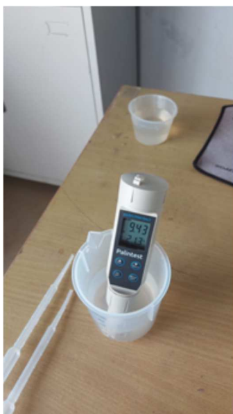
Ph 37. Multiparamètre d'analyse des paramètres physico-chimiques de l'eau
