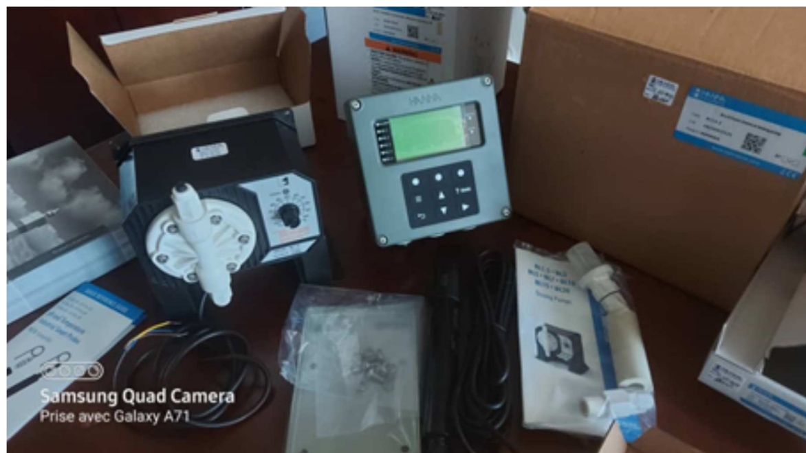
Photo 18. Pompe doseuse et unités de contrôle/ South-Africa
