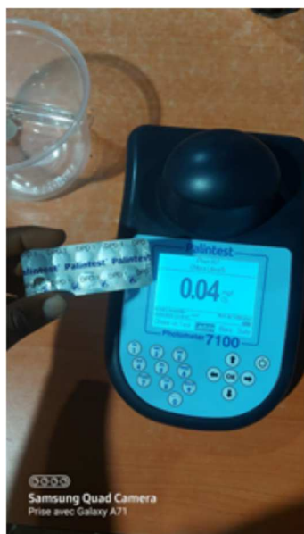
Ph 36. Photomètre d'analyse des paramètres physico-chimiques de l'eau
